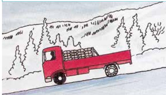
При расположении груза в передней части автомобиля может возникнуть необходимость в использовании цепей противоскольжения на задних колесах.
