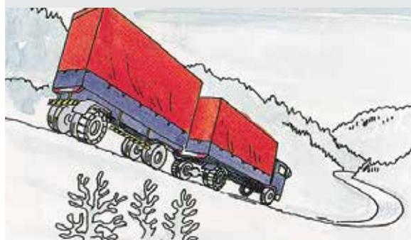
Использование цепей противоскольжения повышает сцепление с дорогой и стабильность при торможении.
